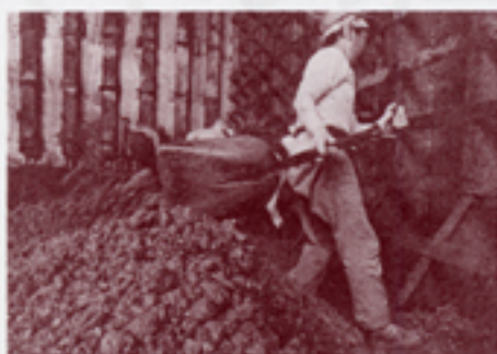
「モッコ取り」と呼ばれる作業を行う女沖仲仕たち。船底のダンブル（貨物置き場）に積まれた鉄鉱石をスコップですくい、モッコ（網状の運搬器具）に入れていく。
